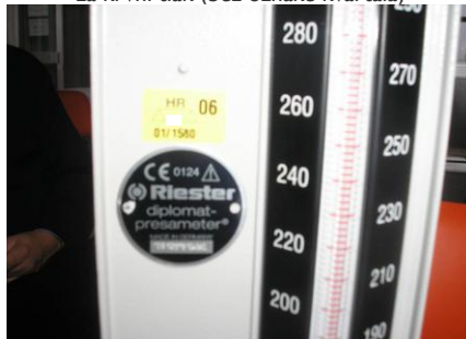
I.b. Nepropisne ovjerne oznake na tlakomjerima za krvni tlak (bez oznake kvartala)
