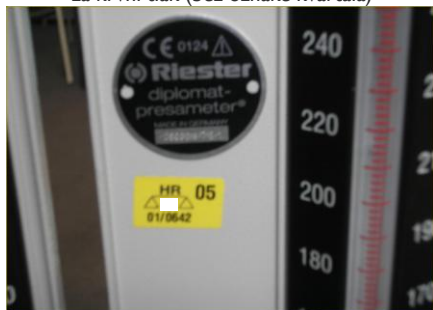
I.a. Nepropisne ovjerne oznake na tlakomjerima za krvni tlak (bez oznake kvartala)
